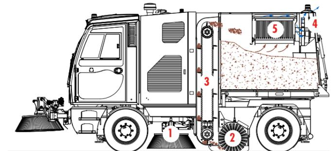
Los residuos se recogen gracias a la acción mecánica de los cepillos laterales (1) y central (2) y del transportador vertical (3). La finalidad de la aspiración (4) es captar el polvo en cuanto se levanta del suelo. La aspiración está optimizada para permitir la supresión total del polvo gracias al filtro de gran superficie (5).
