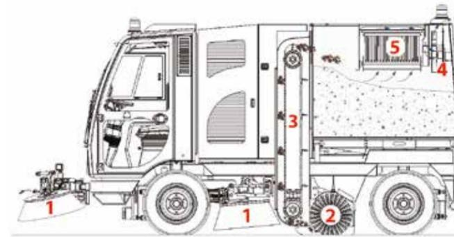
Los residuos se recogen gracias a la acción mecánica de los cepillos laterales (1) y central (2) y del portero vertical (3). La finalidad de la aspiración (4) es captar el polvo en cuanto se levanta del suelo. La aspiración está optimizada para permitir la supresión total del polvo gracias al filtro de gran superficie (5).
